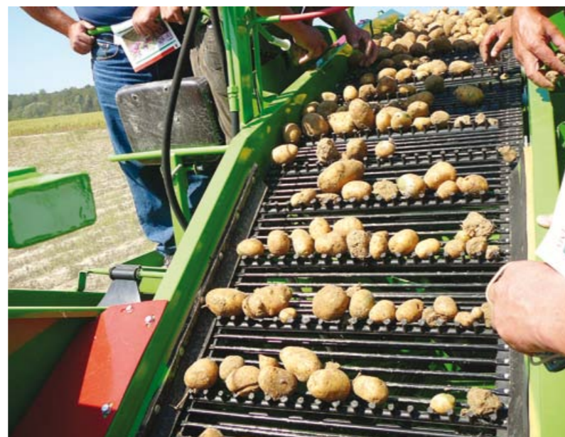
Резиновые элементы конвейерных уборочных комбайнов PYRA гарантируют незначительное число поврежденных клубней
