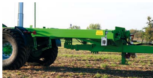
В стандартной опции прицепы оснащены амортизирующей тяговой рамой, которая поглощает все вибрации
