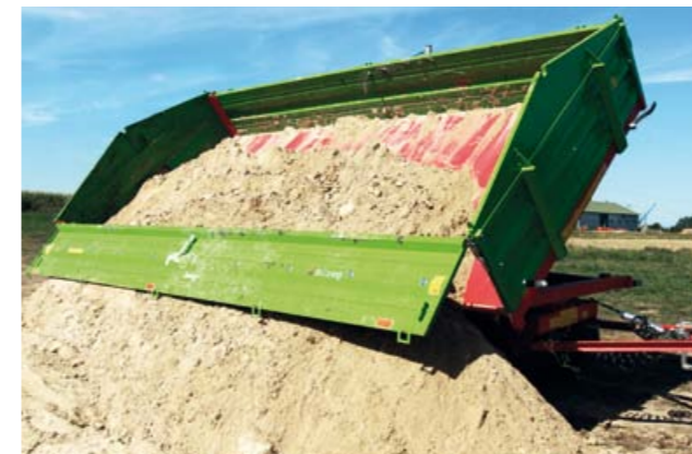
P long – создан для транспортировки тяжелых грузов (от песка до камней). Технически разрешимая загрузочная мощность прицепа P14 Long – 14000 кг
