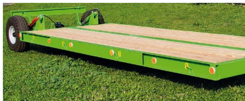
На левой и правой стороне находятся 4 ручки для фиксации ремней в целях обеспечения сохранности транспортируемого груза
