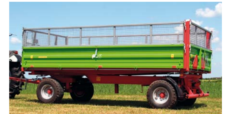
P long – создан для транспортировки нефасованного материала, лежащего насыпью (от дробленого зерна до сухого фуража). Благодаря наличию сетчатых надставных бортов высотой 1000 мм, увеличивается загрузочный объем прицепа P6 long до 20 м 3
