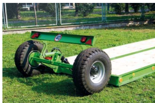
Гидравлически опускаемый пол платформы PL6 опускается до самой земли, чтобы обеспечить легкость в погрузке техники
