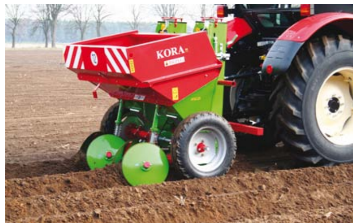
Классическая двухрядная картофелесажалка с бункером на 400/450 кг
