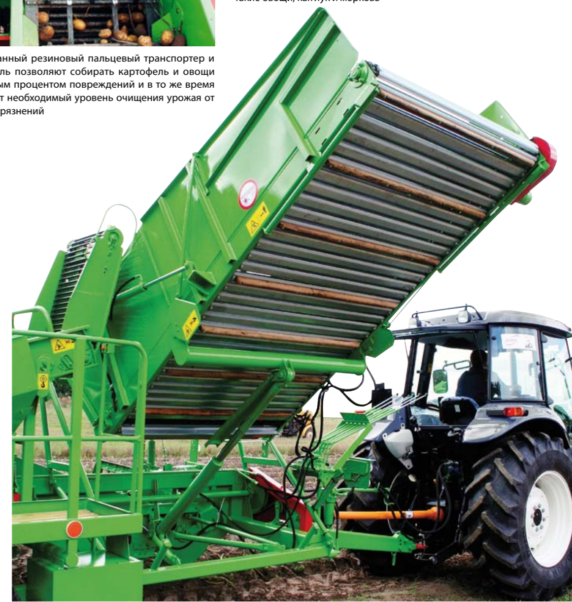
Уборочный комбайн PYRA 3000 оснащен гидравлическим механизмом подъема бункера, который позволяет выгрузить урожай на высоту до 3,7 м., а PYRA 1600 оснащен бункером, позволяющим выгрузить урожай на высоту до 2,7 м
