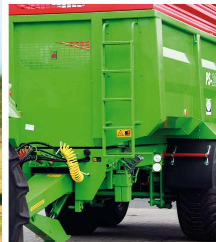
Окно для наблюдения, крытое прозрачным акриловым материалом, лестница и ступени внутри кузова, помогают контролировать загрузку
