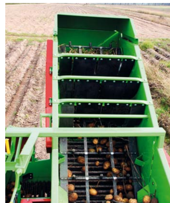
Отрегулированный резиновый пальцевый транспортер и ботвоудалитель позволяют собирать картофель и овощи с минимальным процентом повреждений и в то же время поддерживают необходимый уровень очистки урожая от всех видов загрязнений
