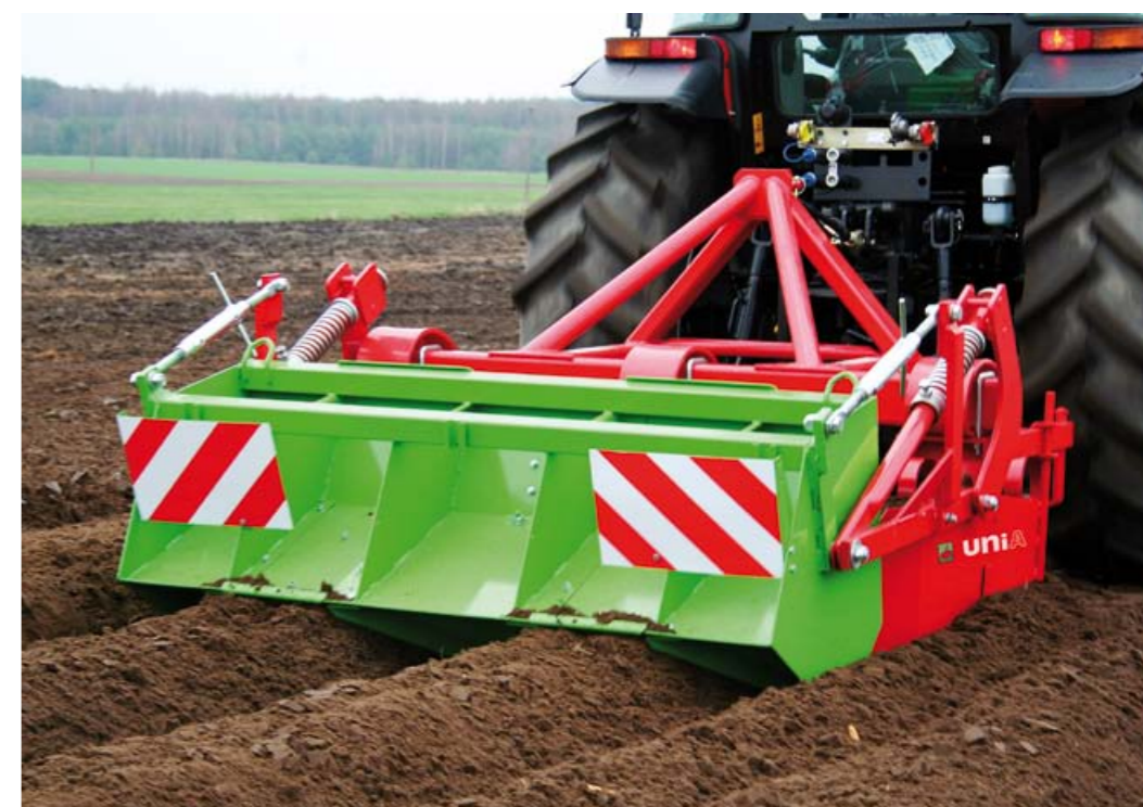
Форма 2/4 - это гребнеобразователи двух и четырехрядные с формирующим устройством, что позволяет получать трапециобразную форму бороздам. Междурядная ширина может регулироваться от 70 до 75 см
