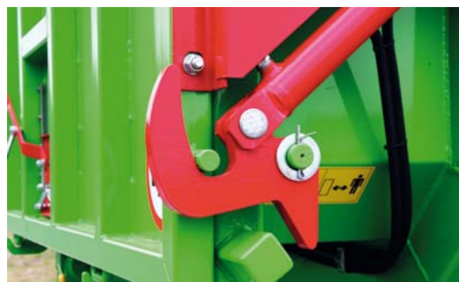
Автоматическая блокировка борта слева при помощи затворов, что гарантирует герметичность бункера
