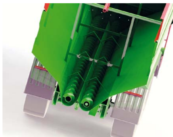
Два шнековых конвейера расположены на дне грузового бункера для быстрой разгрузки. Три отверстия на дне (под гидравлическим управлением) позволяют опустошить прицеп до последнего зерна
