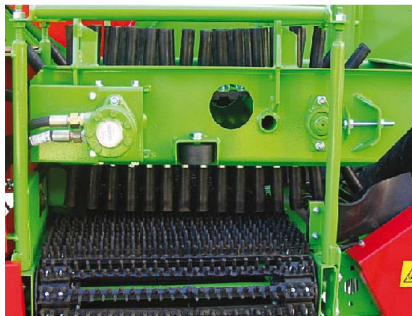
Резиновые элементы конвейерных уборочных комбайнов PYRA гарантируют незначительное число поврежденных клубней
