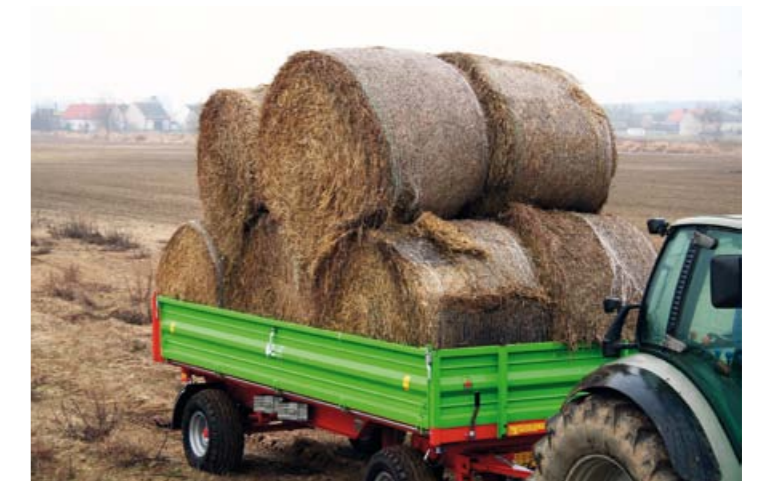
P long – создан для транспортировки рулонов из соломы (возможность загрузки до 12 рулонов диаметром 120 см). Длина загрузочного отсека 5,25 м, ширина 2,42 м.
