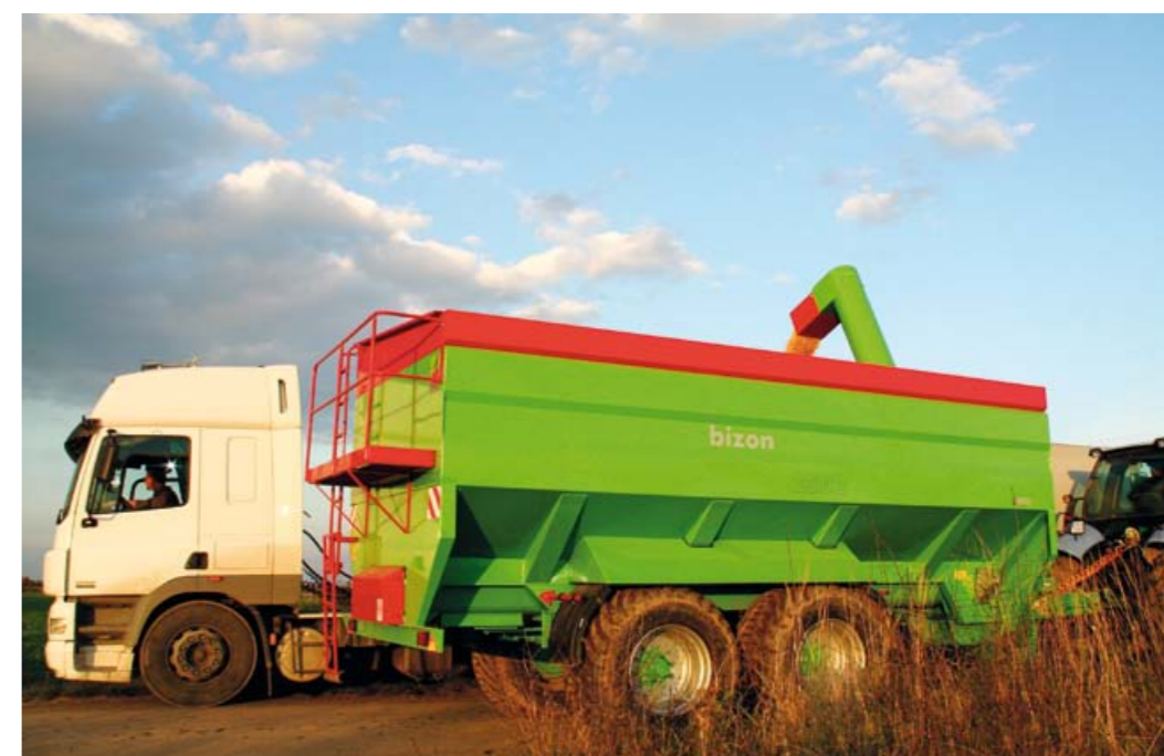
Высоко поднятая разгрузочная труба позволяет перегружать зерно в прицепы или грузовики
