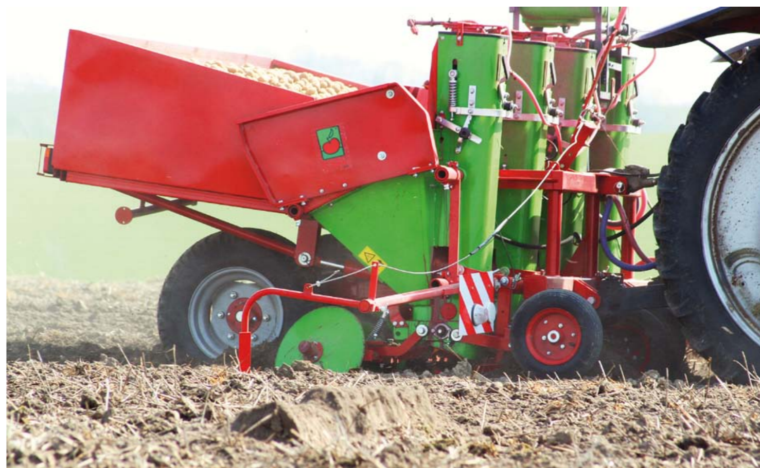
Четырехрядная сажалка для картофеля с гидравлически поднимающимся бункером, вместимостью 1100/1150 кг
