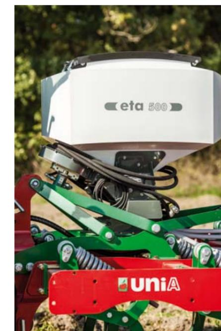
ETA500 с гидравлическим приводом. Рабочая ширина может варьироваться 1-7 м (8 выходов), 1-12 м (16 выходов)
