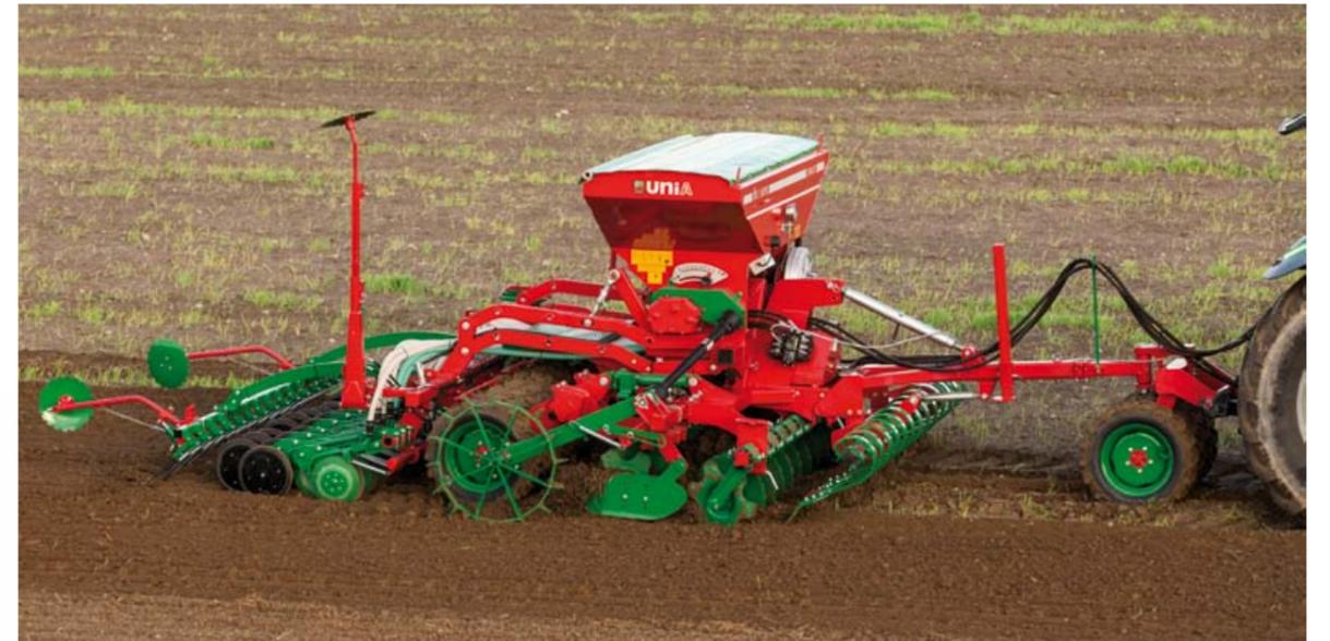
Сеялка FS может быть представлена в полунавесном варианте (приводная система) или навесном
