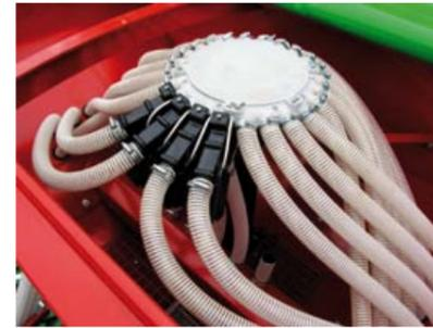
Электроклапаны, установленные на высевных линиях, для технологических дорожек
