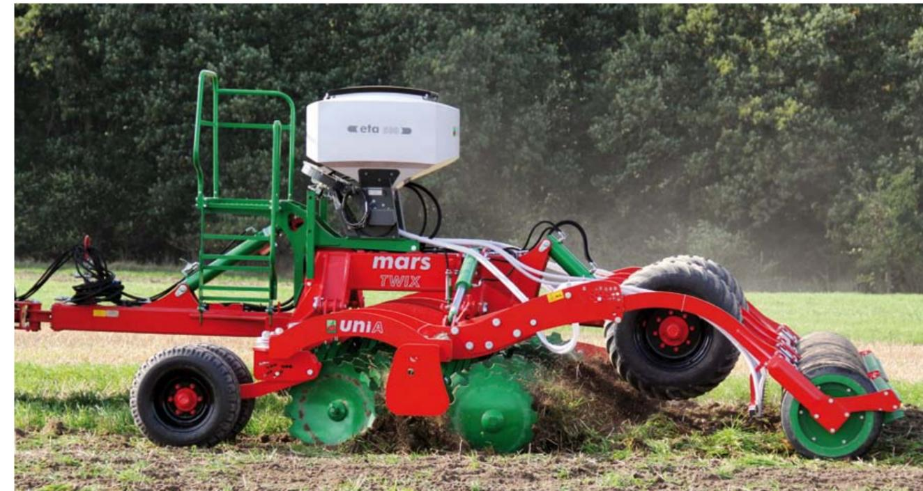
Пневматическая сеялка с распределителем семян ETA – можно высевать мелкие семена растений и травы
