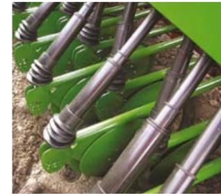
2-х дисковые сошники сеялки расположены на расстоянии 26 см друг от друга в «шахматном» порядке, что обеспечивает бесперебойную работу без забивания. Также диски сошника расположены со смещением: производится самоочистка сошника, облегчается разрезание пожнивных остатков, улучшается проникновение сошника в почву, снижается налипание влажной почвы на диски. Использование закрытого подшипника увеличивает надежность данного узла.
