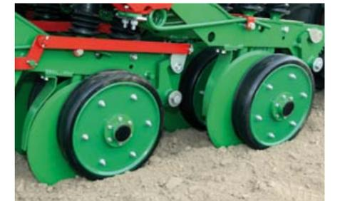
Двухдисковый сошник с копирующим колесом – давление 40 кг/сошник. Рекомендован для посева по традиционной технологии почвообработки
