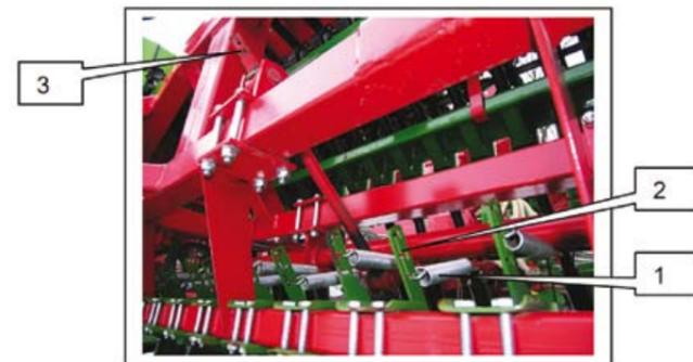
Для регулировки давления сошников сеялка оборудована центральным гидравлическим прижимом (3). Также каждый сошник имеет индивидуальную пружину (2 и 1) – для индивидуальной регулировки заглублиения.
