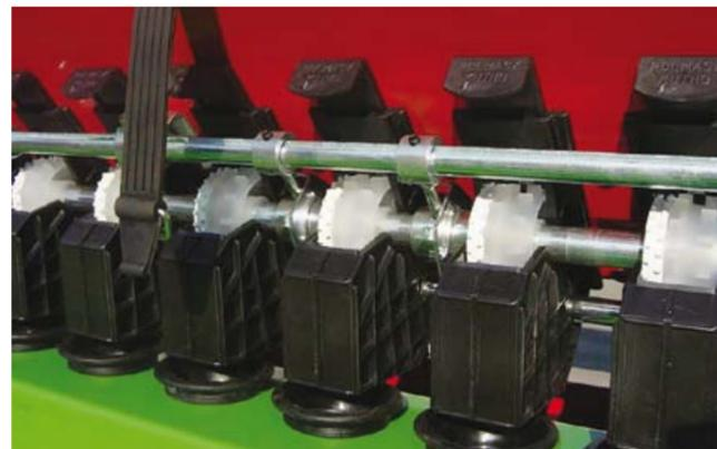
Катушечный дозирующий механизм и бесступенчатая коробка передач обеспечивают точность и равномерность посева. Катушки выполнены из высокопрочного пластика, специальная конструкция позволяет высевать и зерновые, и мелкосеменные культуры без замены катушки.
