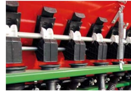
Amber Duplo в дополнение к высевному аппарату оснащен аппаратом по удобрению почвы и разделенным бункером для зерна и удобрения
