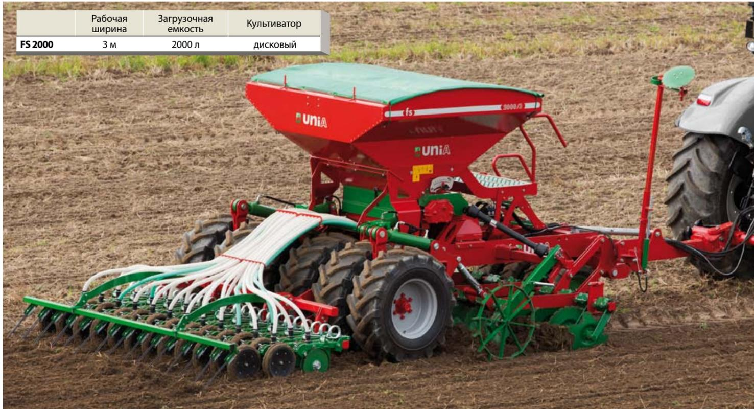
Каток с пневматическими колесами диаметром 1100 мм = стабильная работа при любых условиях
