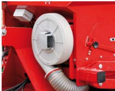
С помощью давления, генерируемого вентилятором, приводимым в движение гидравлическим двигателем, зерно буквально вдавливается в почву с большой силой
