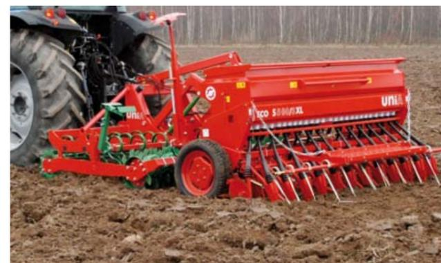
Механический посевной агрегат может быть подвешен на гидравлическую сцепку различных культиваторов
