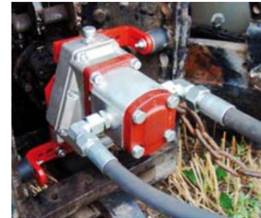
Гидроприводной насос емкостью 30 л/мин., от ВОМ трактора
