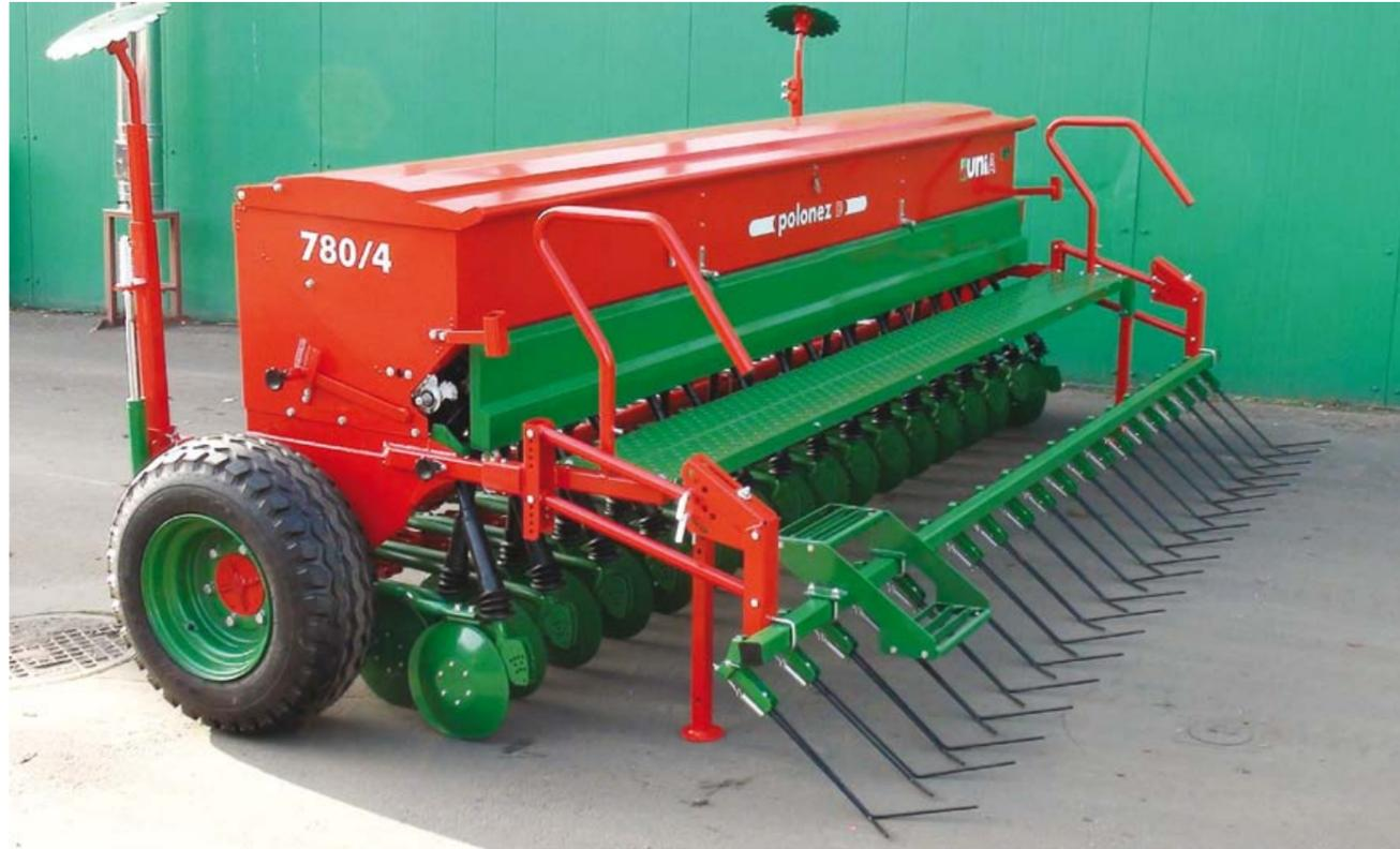
Сеялка POLONEZ предназначена для высевы всех зерновых, зернобобовых и масличных культур, включая рапс, с нормой высевы от 2 до 400 кг на га
