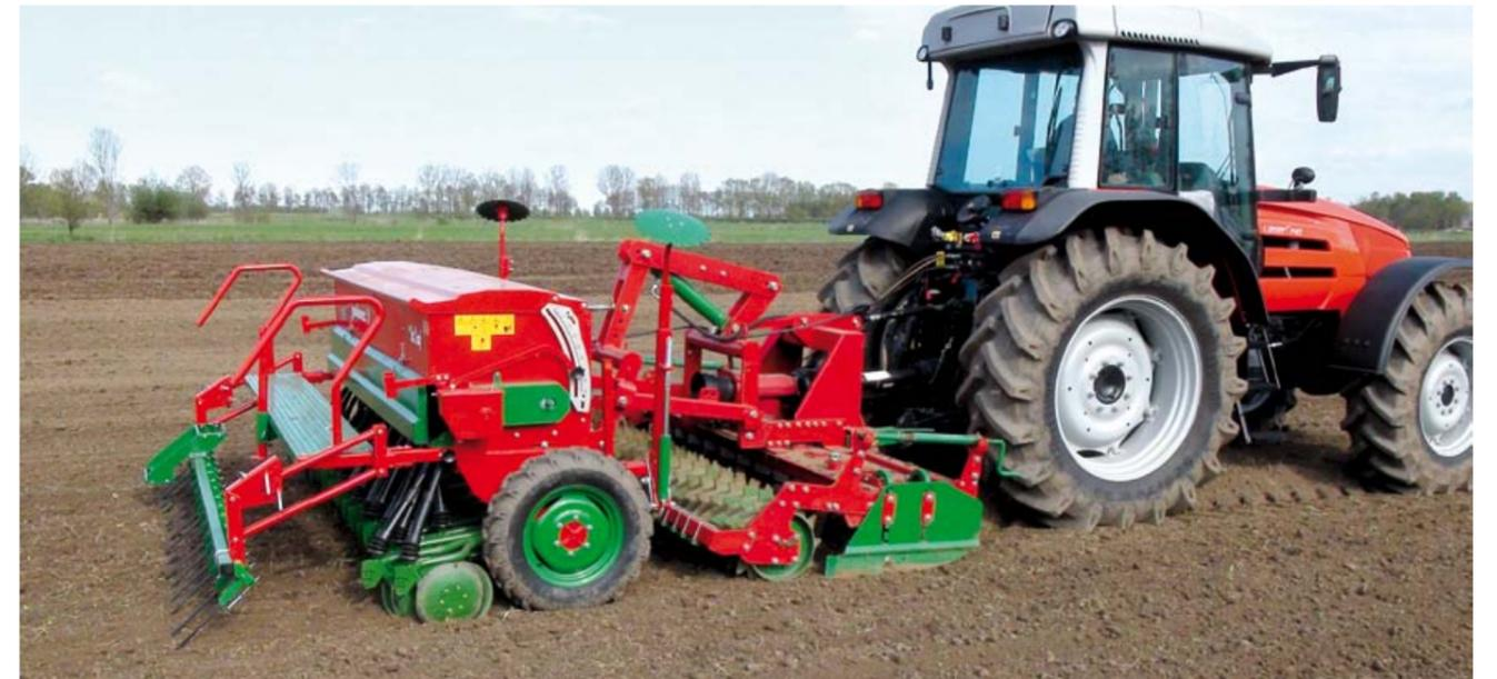
При использовании сеялки Polonez в комплексе с культиваторами Atlas или Ares обеспечивается процесс почвообработки одновременно с посевом за 1 проход
