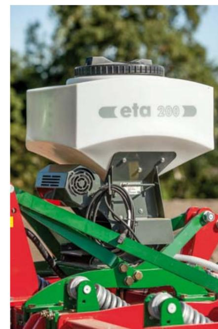
ETA200 с электроприводом. Рабочая ширина 1-6 м
