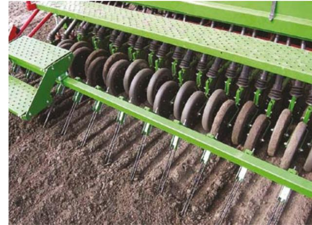
Комплект прикатки – обеспечивает посев на постоянной глубине с удельным давлением 20 кг
