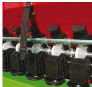
Катушечный дозирующий механизм и коробка передач обеспечивает точность и равномерность посева. Катушки выполнены из высокопрочного пластика, специальная конструкция позволяет высевать и зерновые, и мелкосеменные культуры без замены катушки.
