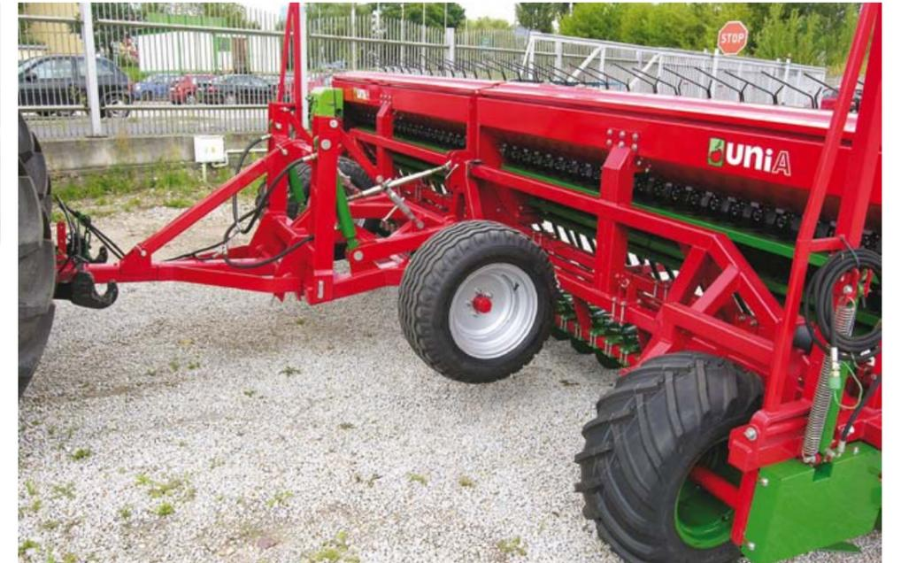
Для агрегатирования сеялки в полунавесном варианте с тракторами мощностью от 80 л.с. можно использовать специальную тележку для сеялки Mazur
