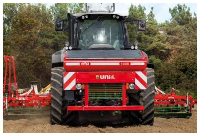
FV 1600, установленный на трехточечном навесном устройстве трактора (бункер емкостью 600 дм<sup>3</sup>, возможен подъем)
