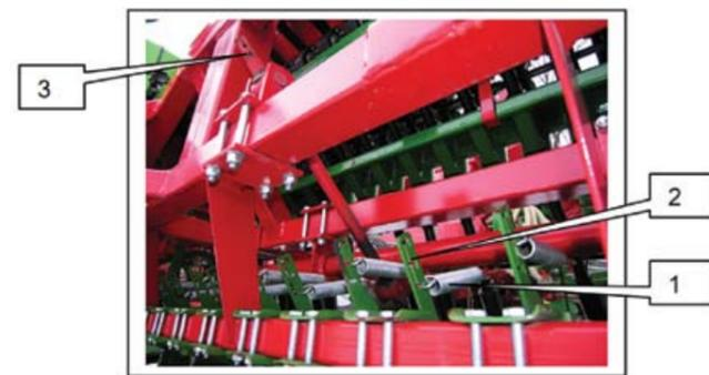
Для регулировки давления сошников сеялка оборудована центральным гидравлическим прижимом (3). Также каждый сошник имеет индивидуальную пружину (2 и 1) – для индивидуальной регулировки заглупления.
