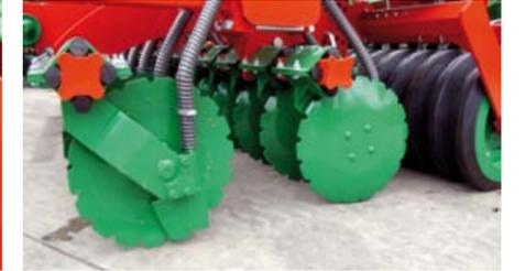
Однодисковый сошник на резиновом амортизаторе – давление 100 кг – рекомендован для посева по технологии минимальной почвообработки
