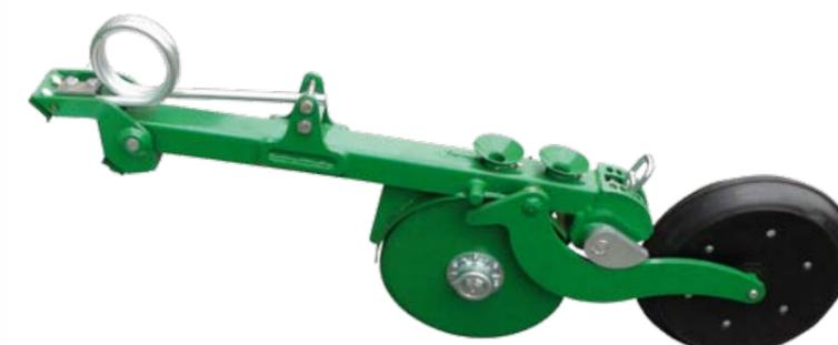
Тяжелый дисковый сошник диаметром 300 мм с копирующим колесом. Давление 40 кг/сошник – FS2000, FS1000 T drive (опция)
