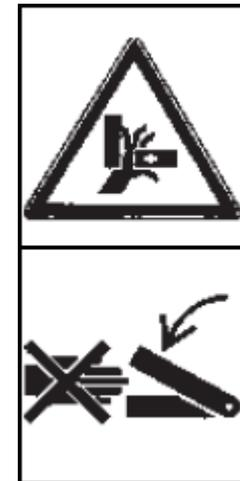
При навешивании агрегатов и задействовании гидравлики запрещено находиться между агрегатами!
