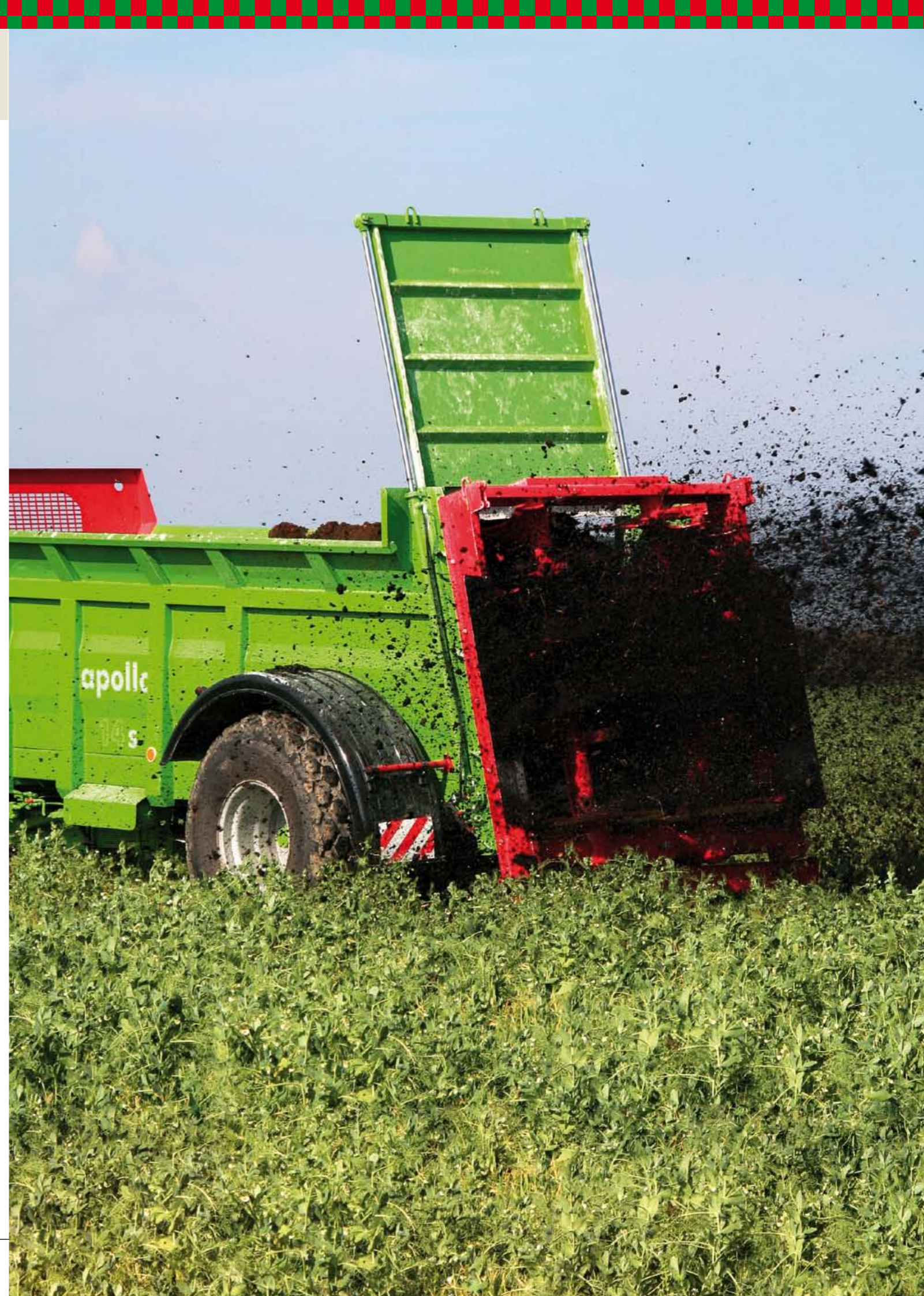
MS SAD – двухдисковый разбрасыватель разработан для того, чтобы разбрасывать удобрения в поле, но также хорошо используется в садоводстве, виноградниках, плантациях хмеля
