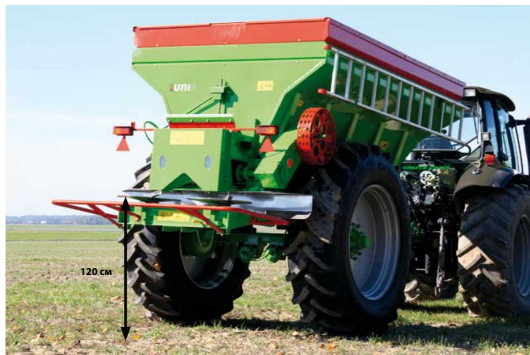
Разбрасыватель RCW 8200 plus M имеет увеличенное расстояние (120 см) от почвы до разбрасывающих органов с защитой
