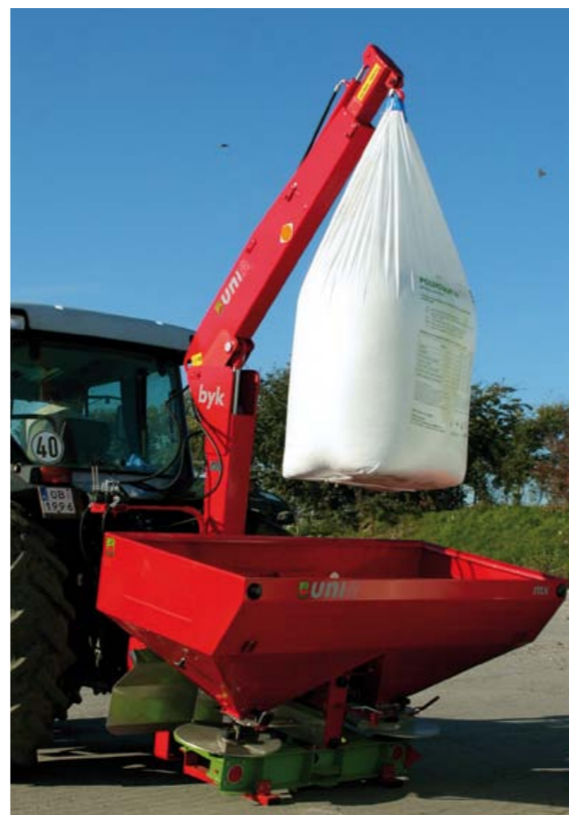
Погрузчик ВУК для быстрой загрузки в поле мешков с удобрениями весом до 1000 кг
