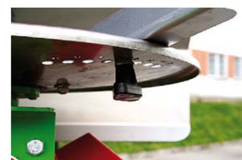
Чтобы изменить рабочую ширину разбрасывания MX, лезвие устанавливается открытым на диске
