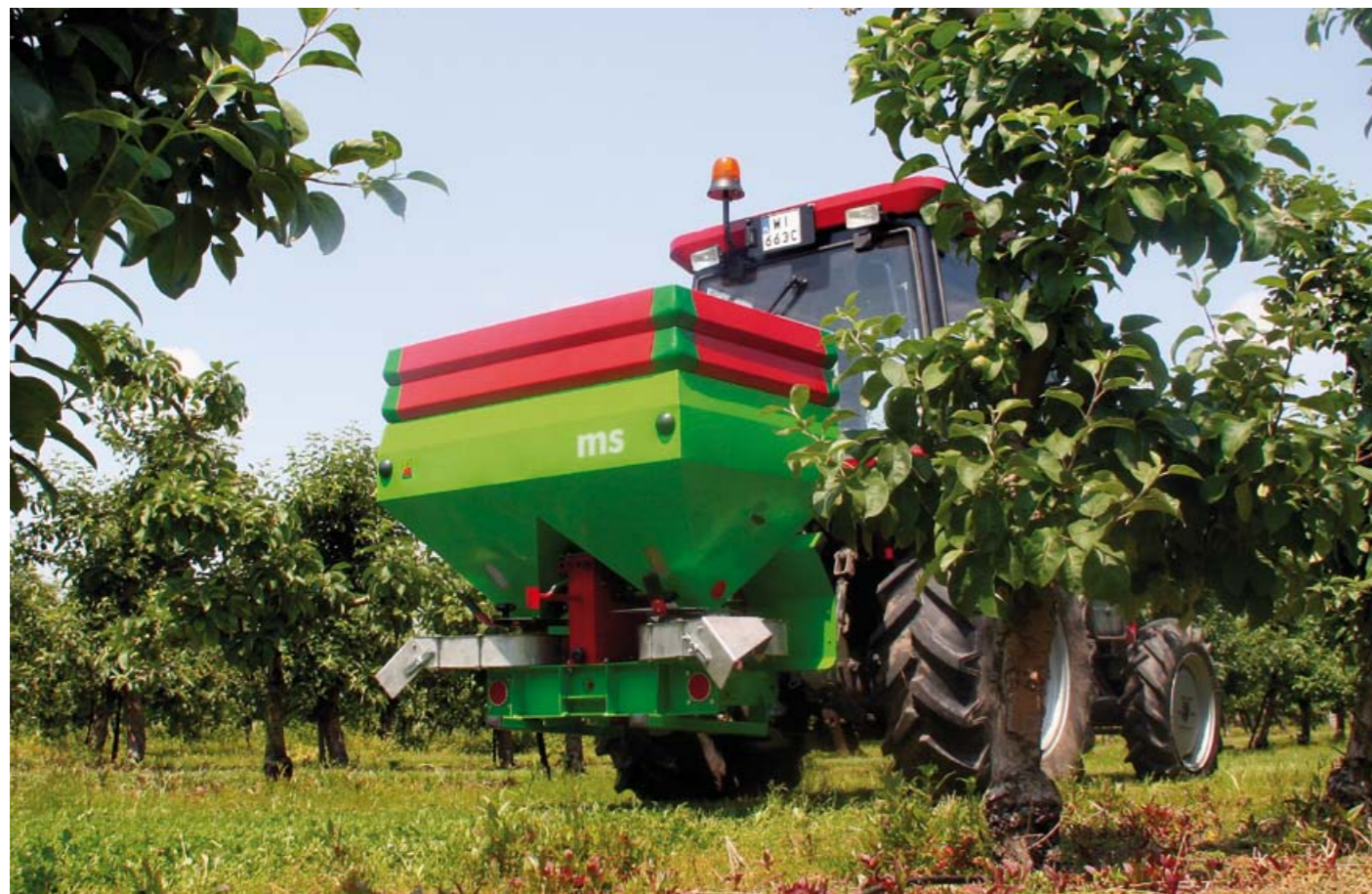
MS SAD – двухдисковый разбрасыватель разработан для того, чтобы разбрасывать удобрения в поле, но также хорошо используется в садоводстве, виноградниках, плантациях хмеля
