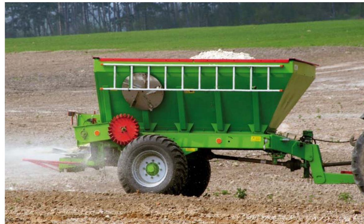
Разбрасыватель RCW с диском, разбрасывающим известь на ширину до 16 метров
