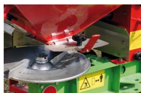
Дозатор количества удобрений открывается в центральной точке диска на нужный размер с помощью подвижного рычага
