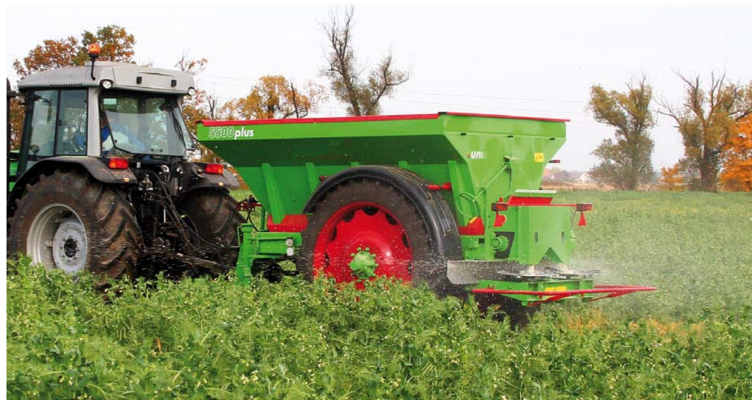
Разбрасыватель RCW с диском, разбрасывающим известь на ширину до 16 метров
