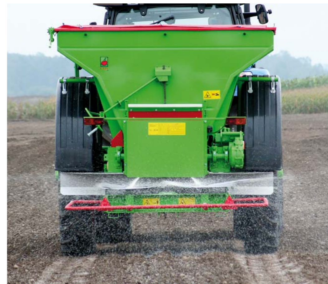
Разбрасыватели RCW 5500 plus имеют узкие и высокие колеса с настраиваемой колеей от 1800 до 2000 мм, RCW 8200 plus – от 2000 до 2200 мм
