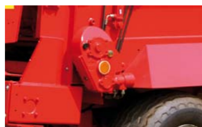
Напольный транспортер, ведомый гидравлической трансмиссией. Специально разработан для тяжелых нагрузок
