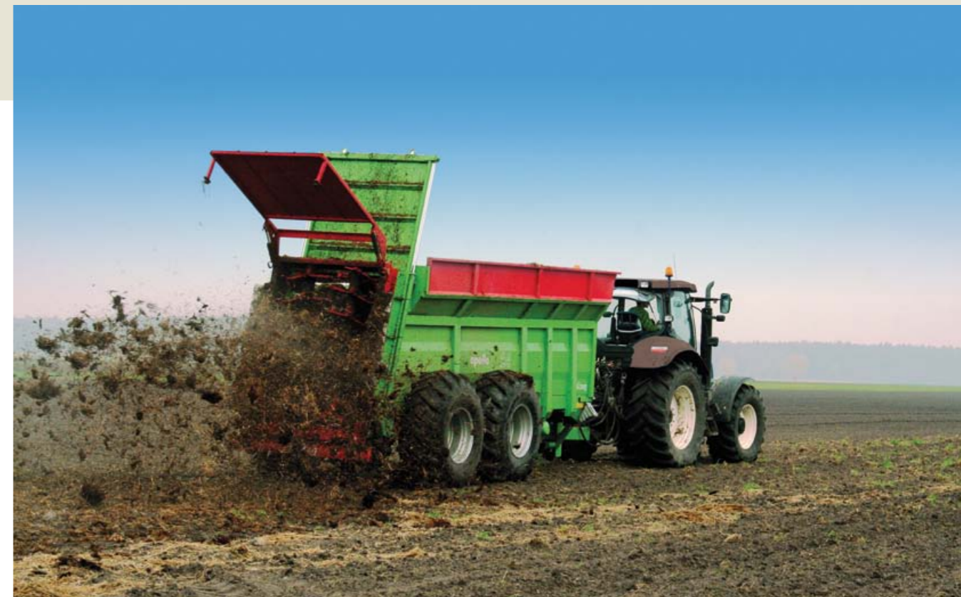
В транспортном положении и при загрузке задвижка существенно снижает давление на разбрасывающий аппарат
