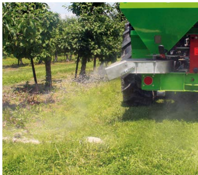
Ширина разброса удобрений MS SAD при помощи пояса до 6 м
