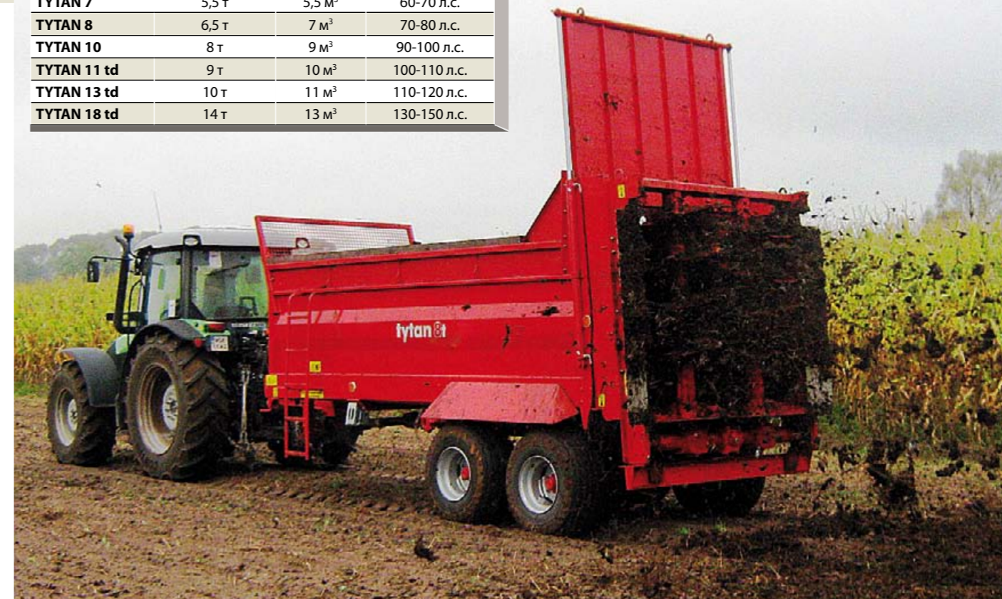
Затвор уплотняет кузов и понижает давление на адаптер
