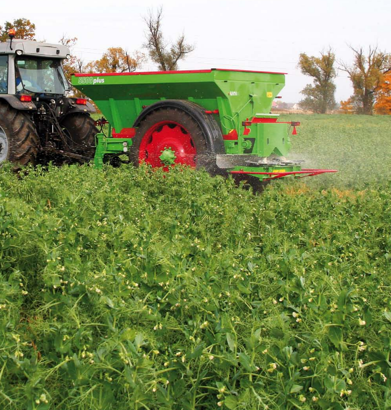
Полное порошковое покрытие всего разбрасывателя или опционно бункер из нержавеющей стали
