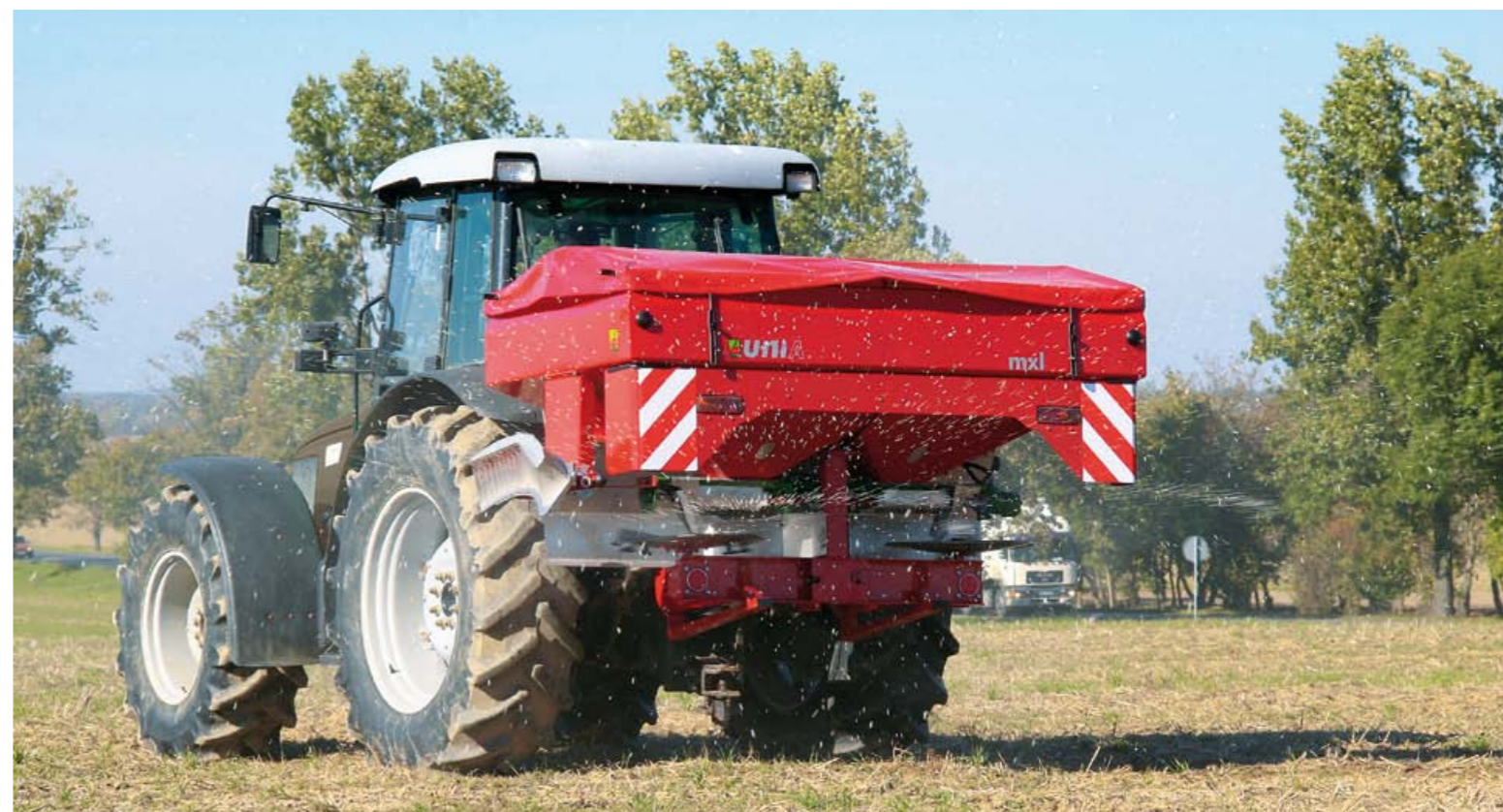
Разбрасыватель MXL может распределять удобрения на ширину до 36 м
