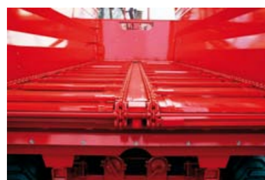
Цепной транспортер разработан для тяжелой работы с любым типом разбрасываемого материала
