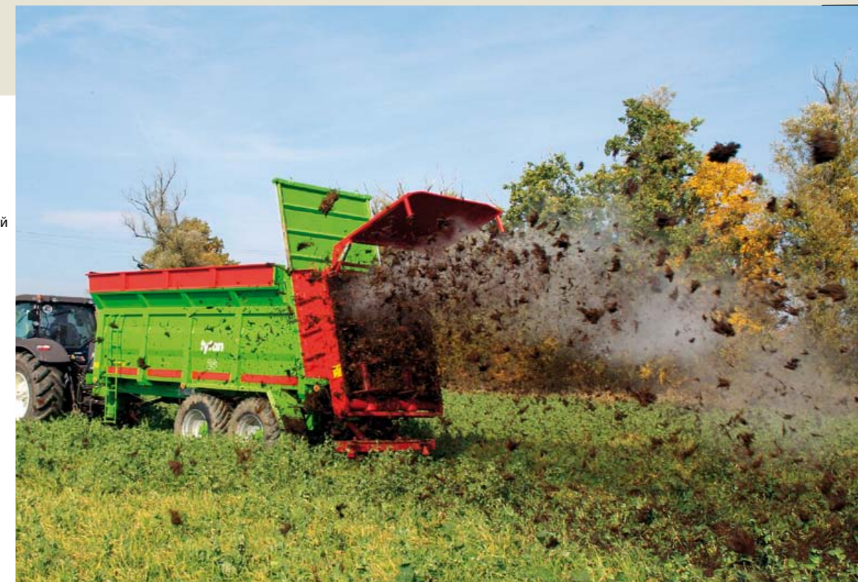
TYTAN – очень мощная машина для точного распространения органических удобрений и извести
