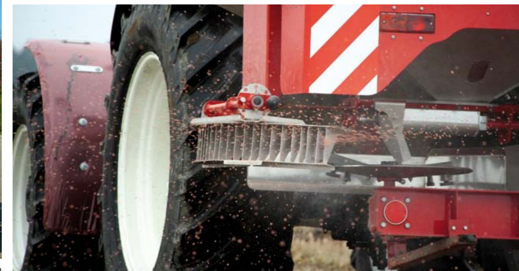
Ограничитель позволяет простым способом получить высочайшую точность разброса гранулированных удобрений на границе поля
