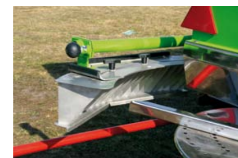
Ограничитель позволяет простым способом получить высочайшую точность разброса гранулированных удобрений на границе поля
