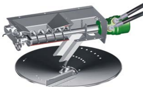
Гидравлически вращаемые шнеки позволяют получать высочайшую точность разбрасывания дозированных удобрений
