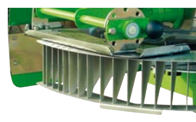
Ограничитель позволяет простым образом получить точность разброса удобрений на границе поля
