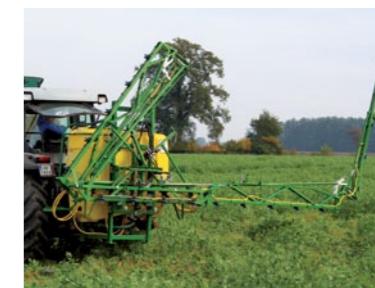
Складывание штанги проводится гидравлическим способом
