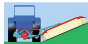
Центральный подвес гарантирует точное копирование рельефа.
