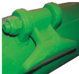
Молотки предназначены для уничтожения наземных частей растений и для измельчения срезанных ветвей деревьев и кустов.
