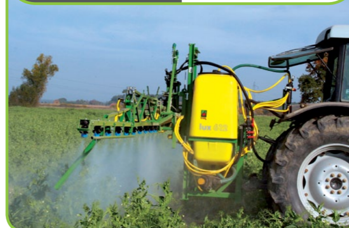
Складывание штанги проводится гидравлическим способом
