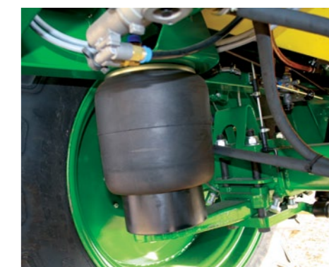
Пневматическая подвеска увеличивает комфорт работы и повышает прочность опрыскивателя
