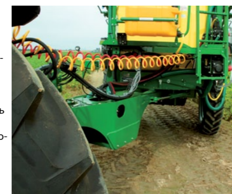
Направление дышла с автоматическим управлением (индукционные датчики) – обеспечивается автоматическое копирование следов трактора
