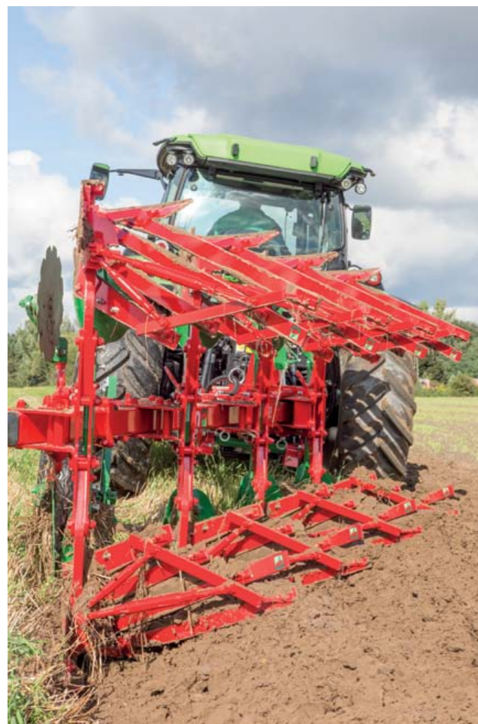
Полосовые (ажурные) отвалы – готовое решение для липких почв, хорошо измельчает почву.
