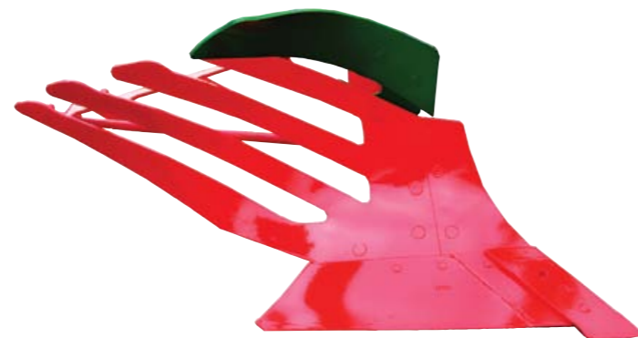
Полосовые (ажурные) отвалы – готовое решение для липких почв, хорошо измельчает почву.
