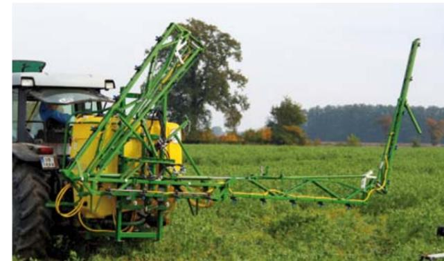
LUX – гидравлика обеспечивает комфорт в складывании и раскладывании полевой штанги
