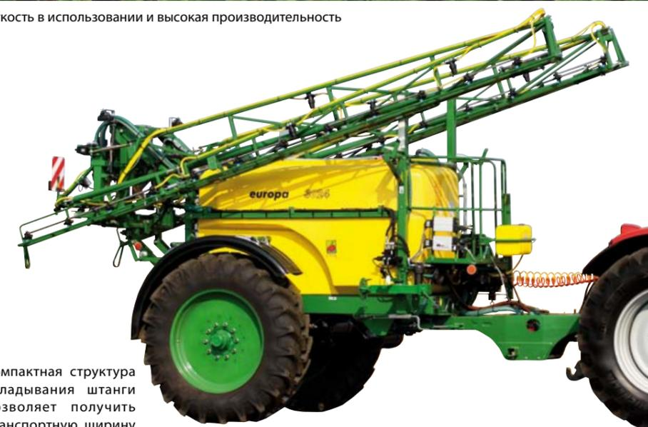
Компактная структура складывания штанги позволяет получить транспортную ширину всего 2,65 м
