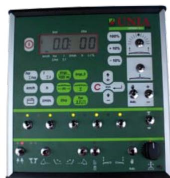
Компьютер SPRAY для контроля за операциями опрыскивателя
