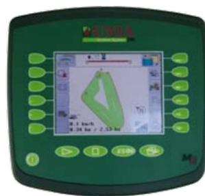
Компьютер UTS, работающий на базе системы ISOBUS, подключенный к GPS – управление параметрами опрыскивания с использованием преимуществ точного земледелия
