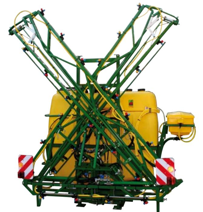
Опрыскиватели LUX с баками емкостью 800 л и 1000 л могут быть оснащены боковым инжекторным смесителем
