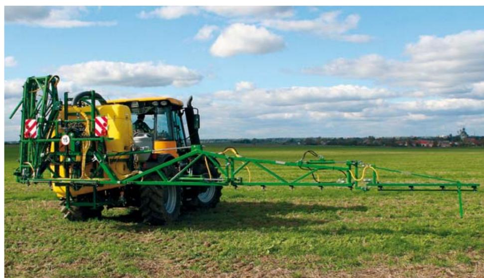
Возможно распыление только одной стороной штанги
