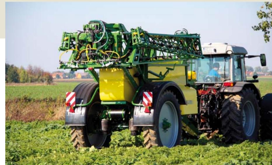
Компактный корпус опрыскивателя имеет транспортную ширину 2,8 м, которая позволяет перемещаться по общественным дорогам
