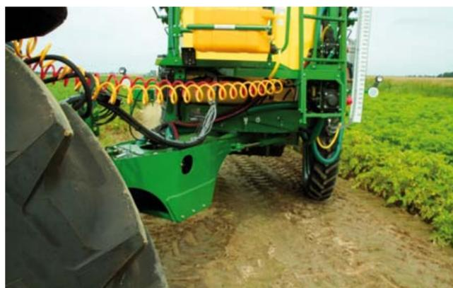
Направление дышла с автоматическим управлением (индукционные датчики) – обеспечивается автоматическое копирование следов трактора
