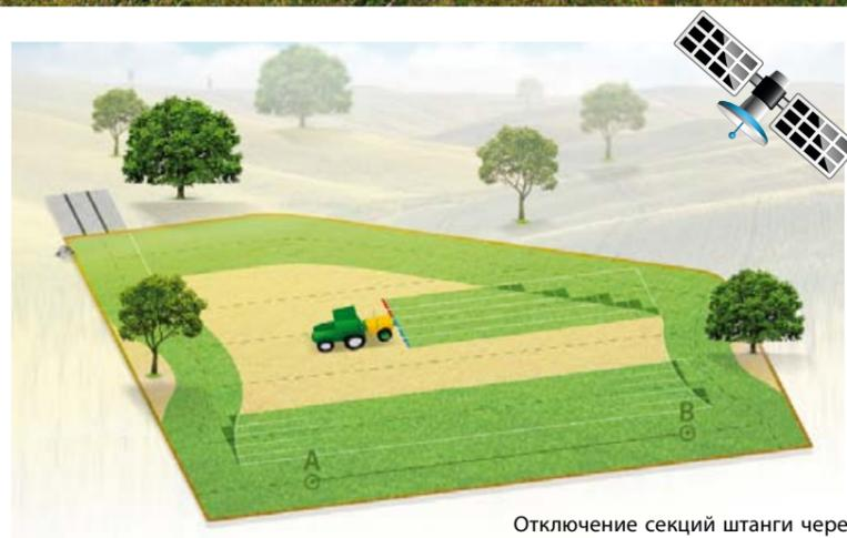
Отключение секций штанги через систему GPS – для исключения избыточного опрыскивания на поворотах и несимметричных полях
