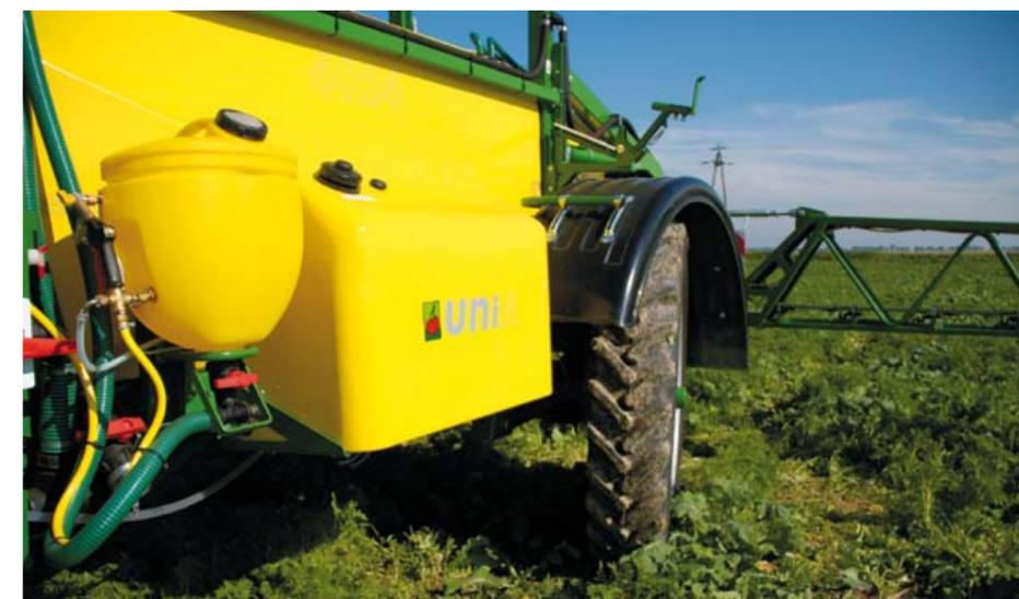
Два бака для чистой воды (2x300 л), расположенные с обеих сторон, позволяют симметрично распределить груз опрыскивателя и обеспечивают водой для очистки основного бака
