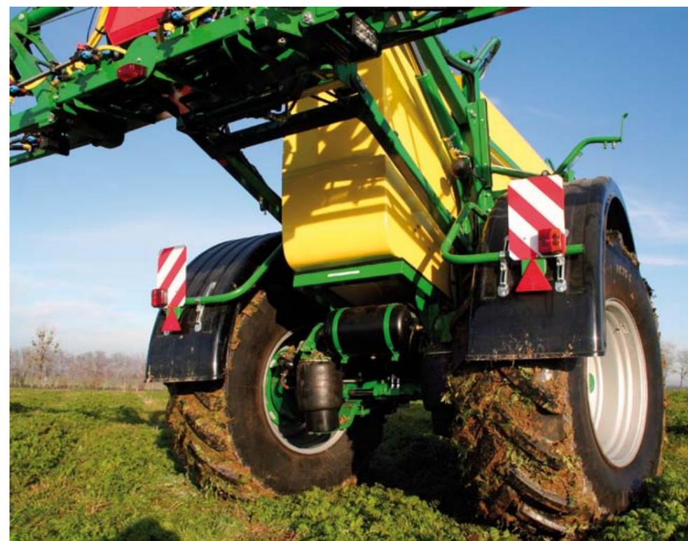
Автоматически управляемая ось – гарантирует точную работу опрыскивателя, следующего по следам колес трактора. Пневматическая подвеска – комфорт работы во время быстрых проездов, эффективно гасит вибрации в полевых условиях
