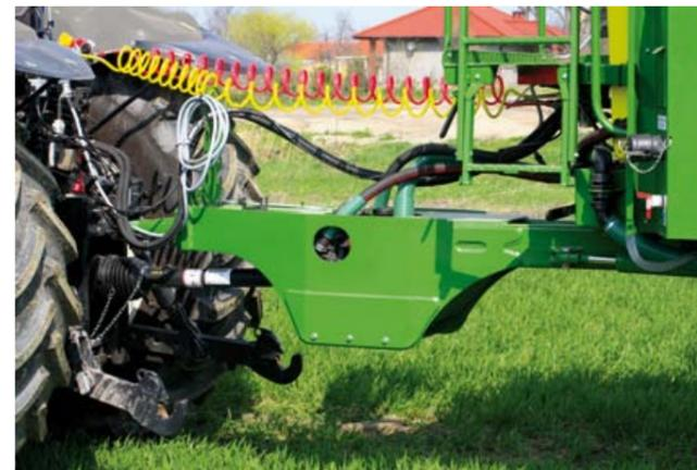
Дышло специальной формы обеспечивает прочность и надежность конструкции и служит для дополнительной механической защиты элементов насоса
