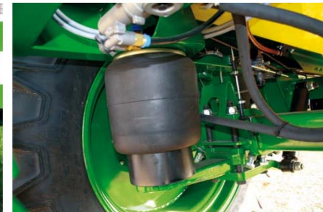
Пневматическая подвеска увеличивает комфорт работы и повышает прочность опрыскивателя
