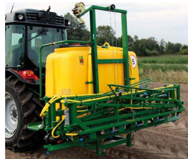
ЕКО – полевая штанга разворачивается, сворачивается или поднимается вручную. Подъему помогает механизм с автоблокировкой, защищающий штангу от падения
