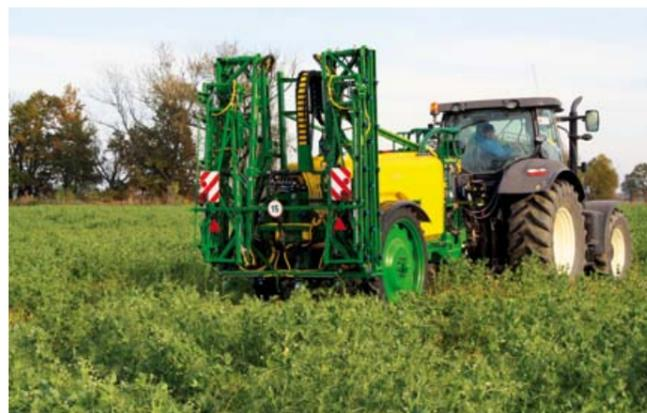
Полевая штанга, свернутая позади опрыскивателя (REX type), доступна для опрыскивателей PLUS с баками 2000 и 2500 л
