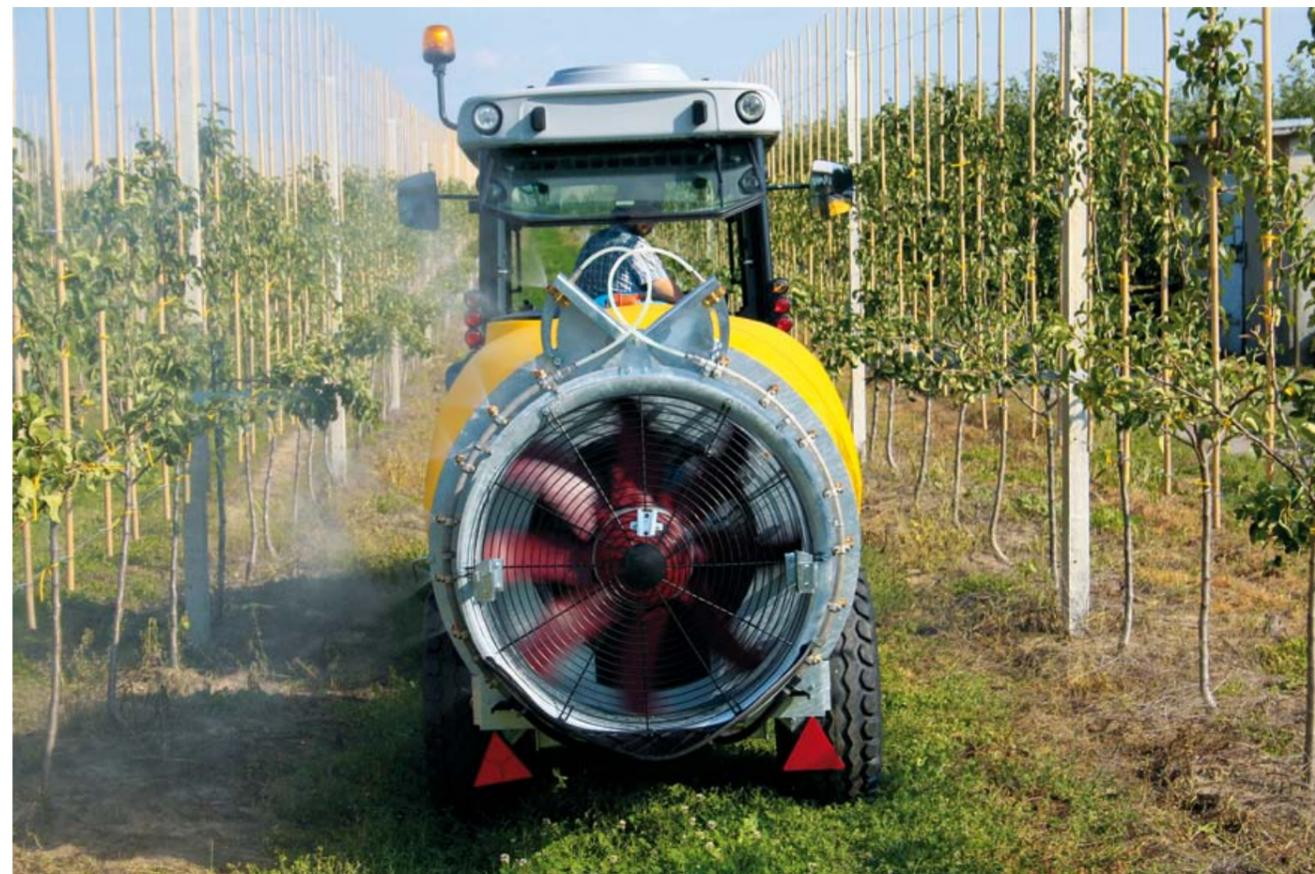
PILMET комплектация диаметром 800 мм, с максимальной производительностью 45000 м³/час и диапазоном 4,5-5,0 м, для традиционного садоводства
