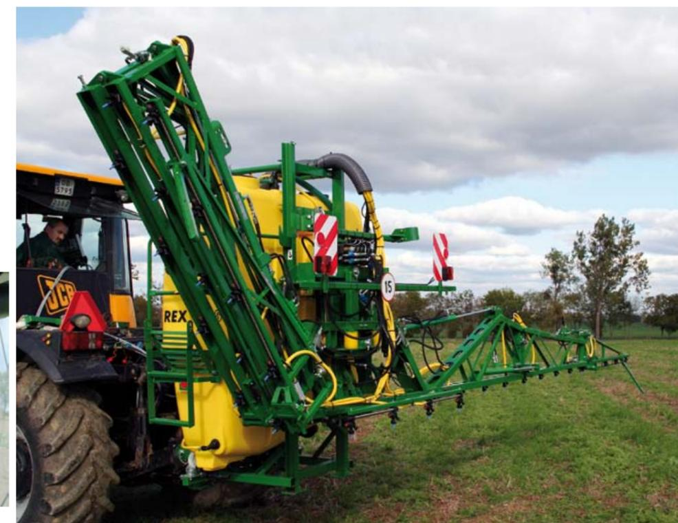
Тщательно продуманная система гидравлического складывания полевой штанги базируется на цилиндрах двойного действия, последовательно управляемых при помощи механических клапанов.
