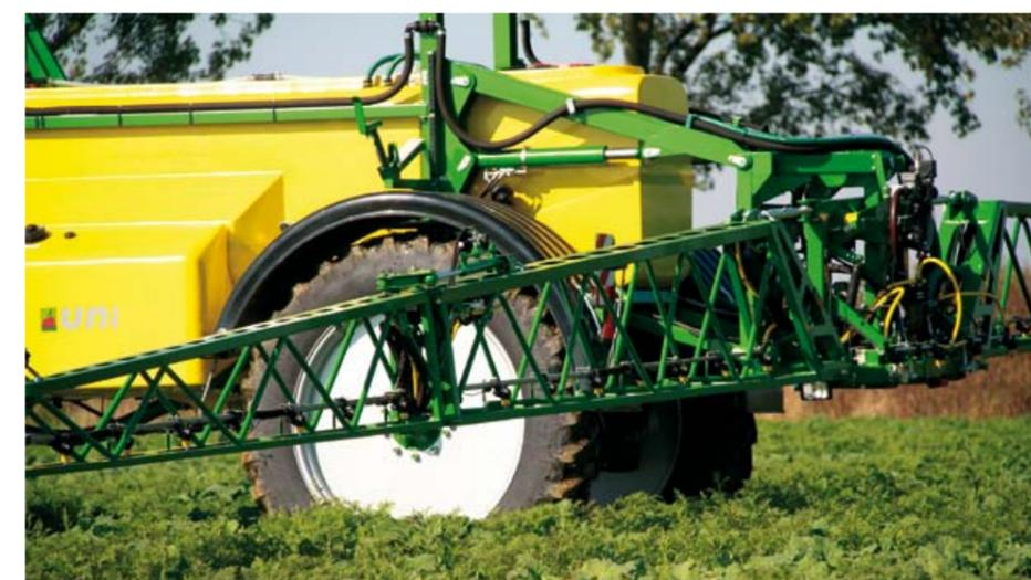
Система выноса штанги на базе четырехугольника с двумя гидравлическими цилиндрами и гидравлическим амортизатором устраняет свободное движение штанги и позволяет поднимать ее до 2,5 м
