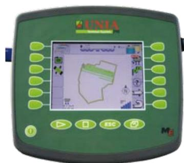
Компьютер UTS с GPS Track Leader II (параллельный проезд и проезд по контуру) и с системой управления секциями согласно с сигналом GPS позволяет точно и удобно использовать возможности опрыскивателя
