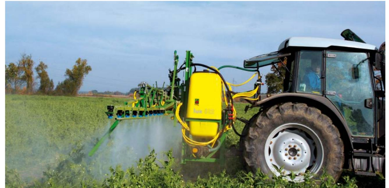
LUX – вся полевая штанга сделана из выгнутого профиля, что обеспечивает большую прочность и жесткость
