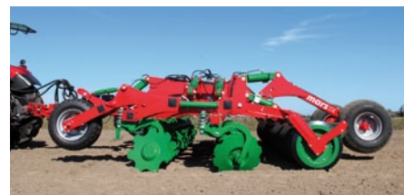
MARS TX полунавесной, гидравлически складываемый, с дисками ø660 мм.
