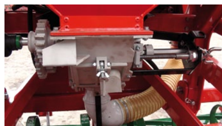
Один высевочный аппарат – легкая регулировка.
