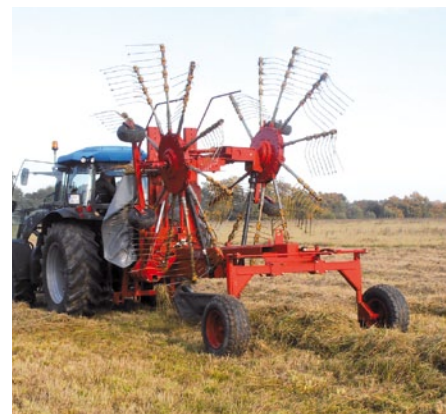
Рабочие роторы складываются при помощи гидравлики в транспортное положение.
