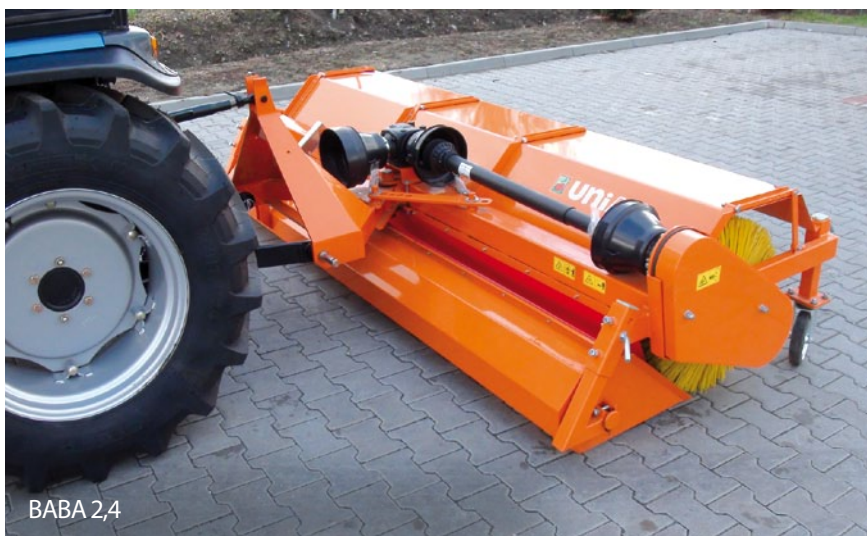
Гидравлический привод щетки передается с гидросистемы трактора через гидроцилиндр.
