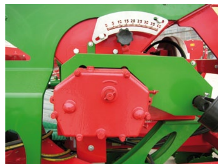
Массивная чугунная бесступенчатая коробка передач..
