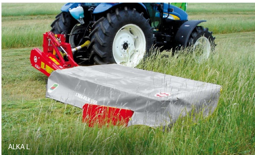
Усиленная рабочая планка с системой быстрой замены ножей и защитой от повреждений.
