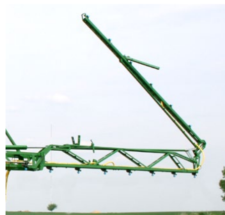
R система – уменьшение рабочей ширины полевой штанги – дополнительная оснастка.
