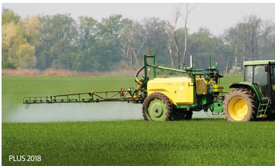
Маятниковая стабилизация с ручной или гидравлической корректировкой наклона штанги.
