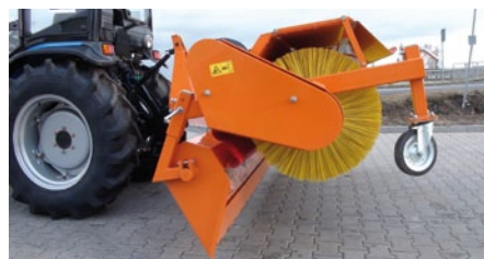
Бункер на мусор опоражнивается механическим способом.
