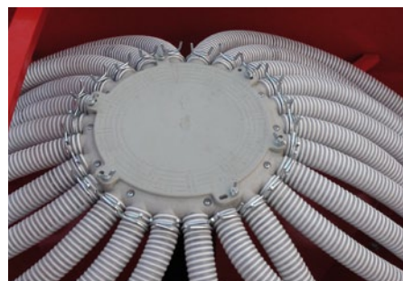
Распределитель зерна находится внутри бункера.
