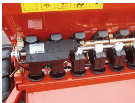
Электрические технологические дорожки управляются при помощи электромотора.
