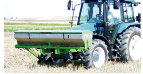
ALFA 750/3 (для удобрений), замонтированная на передней навеске трактора. Гидравлически поднимаемое копирующее колесо.
