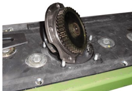
Модульная конструкция планки облегчает проведение ремонта.
