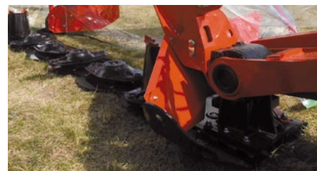
Усиленная рабочая планка с системой быстрой замены ножей и защитой от повреждений.
