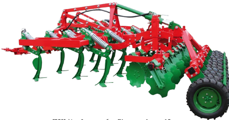
CROSS drive с 3 рядами зубьев CX и дисковой секцией В
