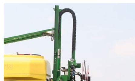
Шинная система выноса штанги с лестничным механизмом проводки шлангов – это защита от заломов.
