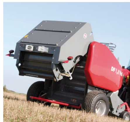
Камера прессования состоит из 8 вальцев спереди и 18 прижимных прутьев в задней крышке.
