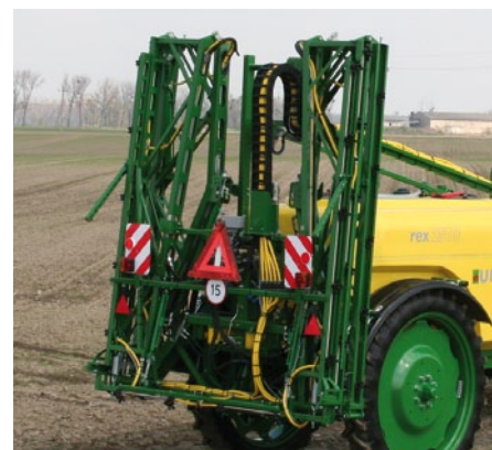
Штанга типа REX с независимым раскладыванием и цилиндром наклона штанги – дополнительная оснастка.
