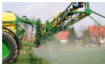
Система выноса на базе четырехугольника с гидравлической амортизацией штанги. Распылители защищены конструкцией штанги.
