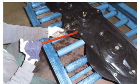
В стандарте – система быстрой замены ножей.
