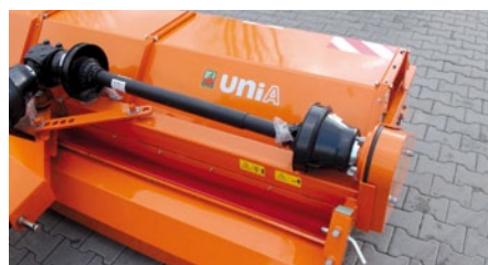
Механический привод щетки передается через ВОМ трактора.
