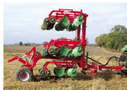
Дисковая версия MAX T, полунавесной вариант, гидравлически сложен к транспортировке
