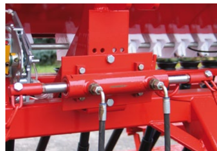
Гидравлический перевод боковых маркеров на одном цилиндре.
