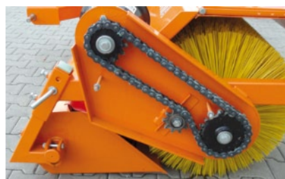
Привод передается на щетку при помощи цепи.
