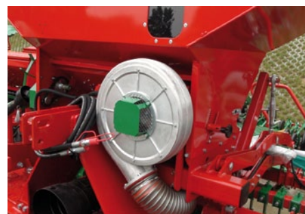
Вентилятор, который приводится гидравлическим двигателем, служит для продувания (перемещения) семян к сошникам..
