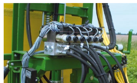
Электрогидравлическое управление функциями штанги при независимом складывании – требует только одной пары гидравлики и два шланга.
