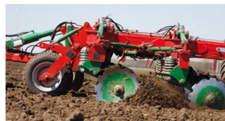
MARS TX полунавесной, гидравлически складываемый, с дисками ø660 мм.
