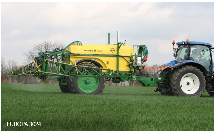
R система – уменьшение рабочей ширины полевой штанги – дополнительная оснастка.
