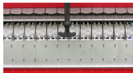
Система высева FS. Количество высевающих аппаратов соответствует количеству сошников.
