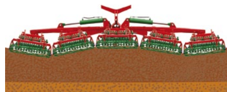
Возможность приспособления рабочих элементов к типу почвы и посева.
