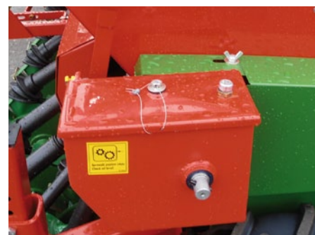
бесступенчатая коробка передач с четкой шкалой регулировок.
