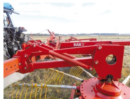
Каждый ротор имеет два копирующие колеса, что позволяет тщательно собирать материал.
