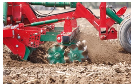
Опциональная дисковая борона типа С идеально подворачивает верхний слой почвы.
