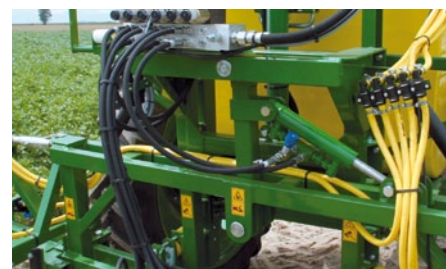
Маятниковая стабилизация с ручной или гидравлической корректировкой наклона штанги.
