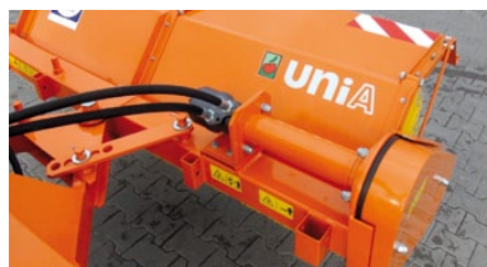
Гидравлический привод щетки передается с гидросистемы трактора через гидроцилиндр.
